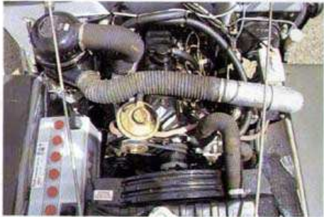
Unverwundlich wie eine gußeisnerne Kaminplatte: Der kernige 2,1-Liter-Saugdiesel von Peugeot ist ein Selbstzünder von altem Schrot und Korn
