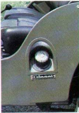
Der Fahrer thront direkt über dem kleinen 40-Liter-Tank. Praxistauglich zeigt sich der großdimensionierte Einfüllstutzen mit abschließbarem Deckel
